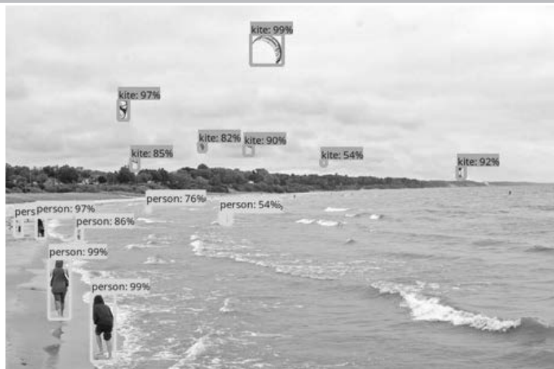
FIGURA 6 MODELOS DE VISIÓN POR COMPUTACIÓN PARA DETECCIÓN E IDENTIFICACIÓN AUTOMÁTICA DE OBJETOS EN IMÁGENES. TECNOLOGÍA OPEN SOURCE DE GOOGLE (TENSORFLOW)
